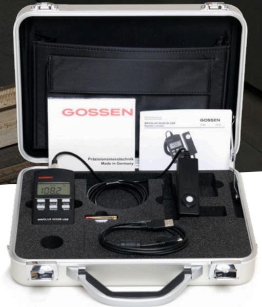
Luxómetro profesional de Clase B según DIN 5032-7, UNE EN 13032-1, Apéndice B y la CIE 69. El excelente ajuste  $V(\lambda)$  y la corrección del coseno permiten una medición fiable de la luz natural y de todas las fuentes de luz artificiales, incluidas los LED. Los cuatro rangos de medida, de conmutación automática o manual, cubren de 0,1 lx a 199900 lux con una precisión de más de 3%.
