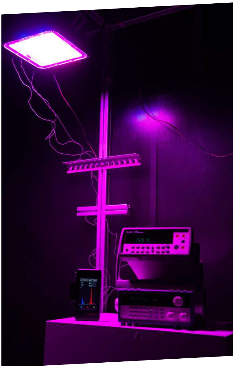
Prueba de medición de temperatura In-SITU (ISTMT) en el laboratorio luminotécnico de ASSELUM.
